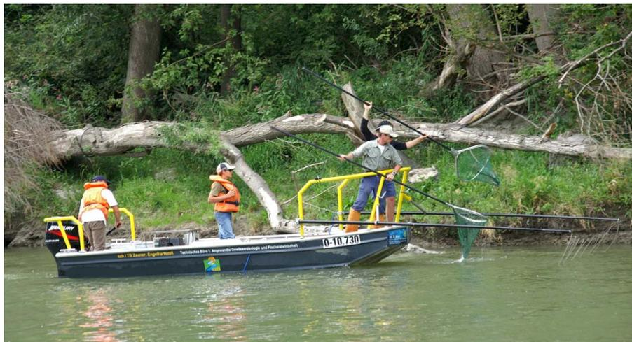
Abbildung 2: Elektrofischung mit dem großen Aluboot und Anodenrechen.
