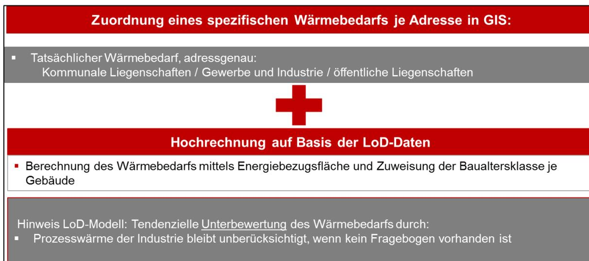
Abbildung 25: Vorgehensweise zur Ermittlung der Wärmebedarfe für den für die Kommunen des Landkreises
