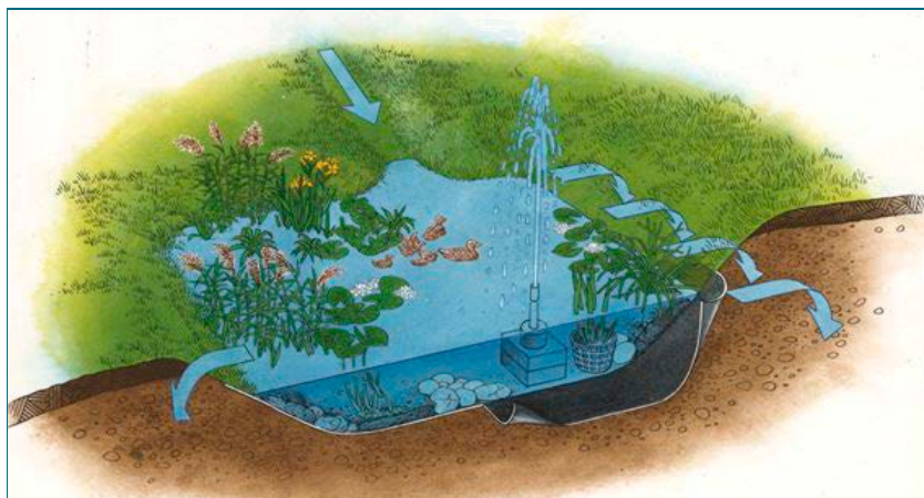
Abb. 6: Abfließendes Wasser kann auch in einen Sickerteich geleitet werden. Im Beispiel versickert das Wasser nicht am Grund, sondern an den oberen Rändern des Teichs. Der Sickerteich kombiniert Versickerung und Rückhaltung.
