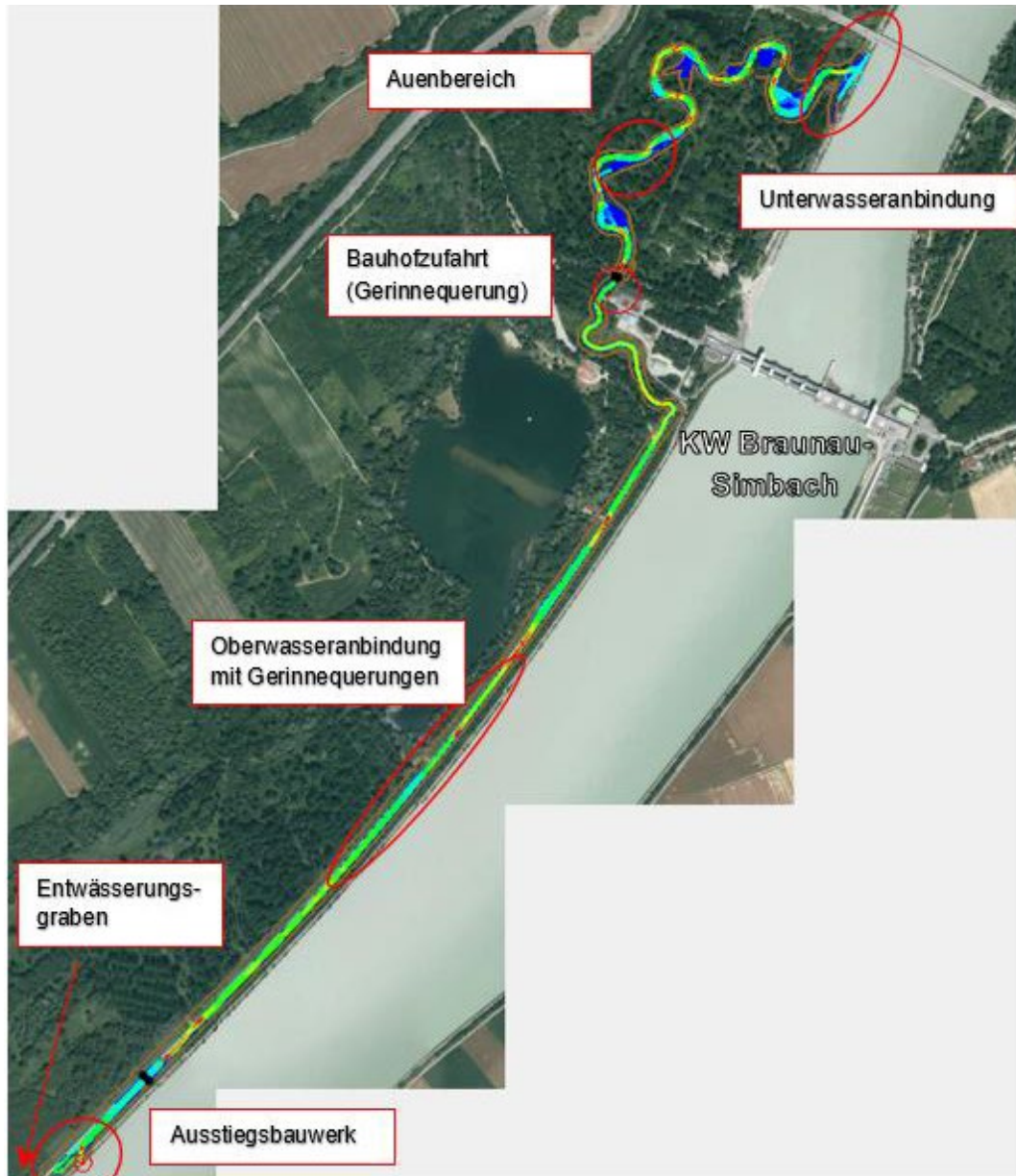
Abbildung 14: Innkraftwerk Braunau-Simbach: Durchgängigkeit und Lebensraum - Übersichtsplan
