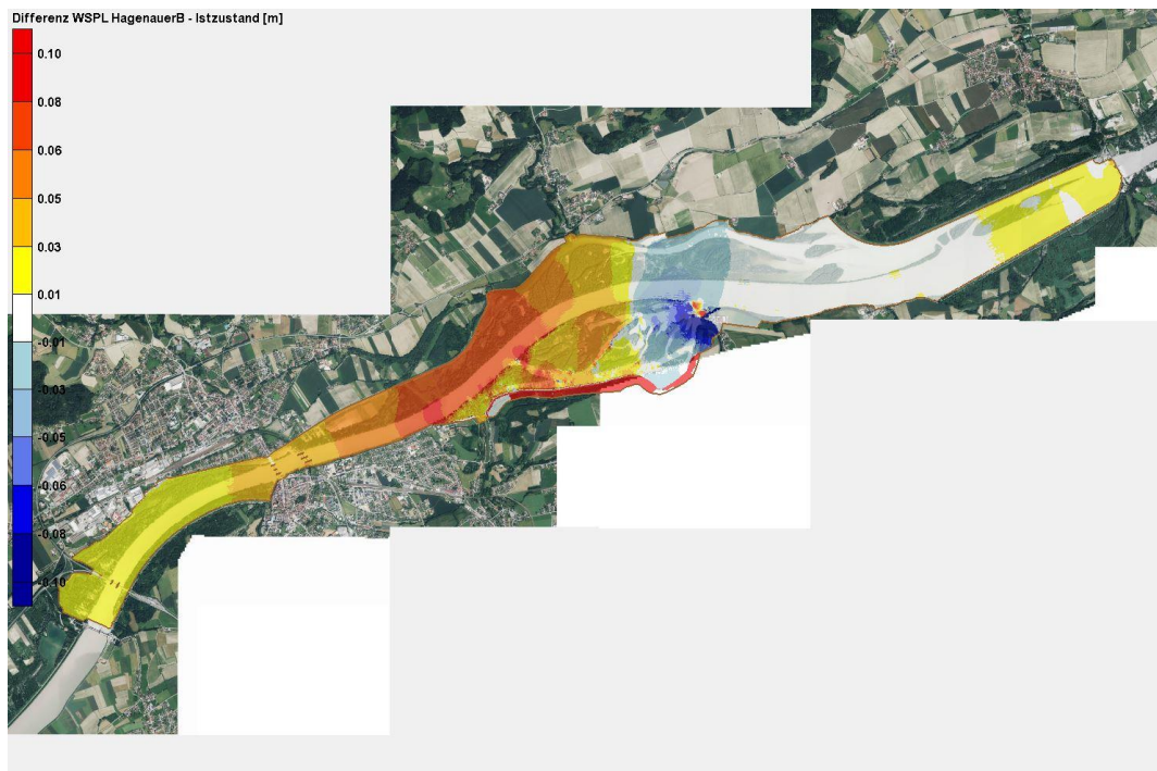
Abbildung 4-3: Differenzdarstellung WSPL BHQ2 Gelände-Gewässersohlenmodell gegenüber Bestandsmodell
