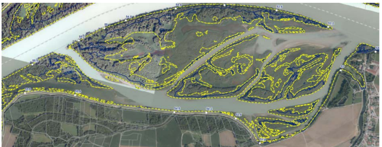
Abbildung 61: Anschlaglinien Bestand MHQ sowie MHQ – 2,0 m in der Hagenauer Bucht (Legende s. Abb. 60)
