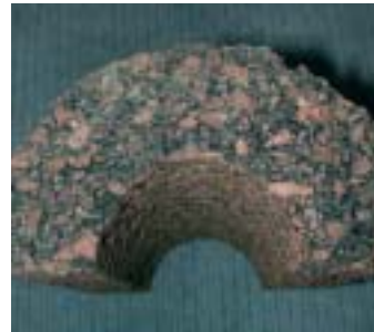
Rohrisolierung aus Teerkork
