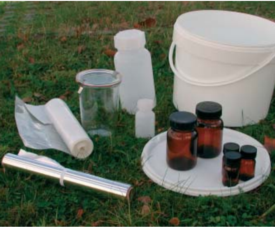
verschiedene Probennahmebehälter (Alufolie, Kunststoffbeutel, Glasbehälter, Kunststoffschraubdeckel- gläser, Glasschraubdeckel- gläser, Kunststoffeimer)
